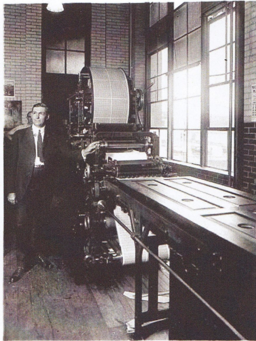
Benjamin Stickney à côté de sa presse rotative. Au départ de rouleaux de papier, la machine imprimait et gommait les timbres-poste.
